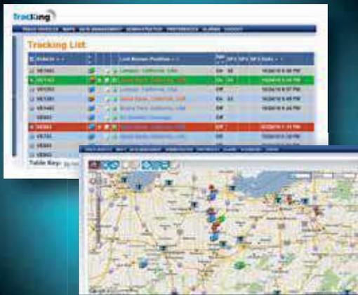
La plataforma de comunicación telemática acoplada REB de ThermoKing le ofrece a los propietarios de flota la capacidad de monitorear sus remolques refrigerados usando tecnología multimodo. Acoplado al controlador SR-4, la plataforma REB se integra al aplicativo TrackKing con base en Thermo King para gestionar sus flotas refrigeradas, ya sea en la carretera como en el patio.
